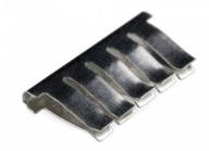
Grazie ad esse, inserendo un filo o un terminale di un componente in un foro, il suo segnale verrà propagato alla semiriga corrispondente (fino alla **separazione** intermedia).
